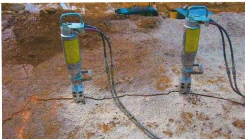
Figura 1 - Rompedor pneumático com cunha hidráulica
